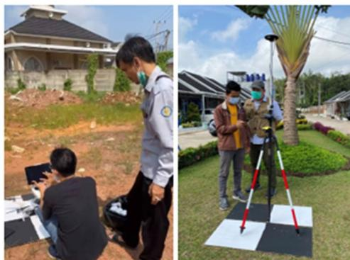
Gambar 4. Proses survei fotogrametri dan pengukuran koordinat serta elevasi GCP
