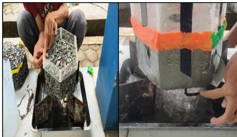
Gambar 6. Pengujian Laju Permeabilitas
