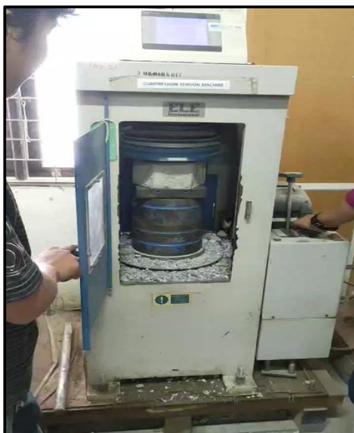
Gambar 7. Pengujian Kuat Tekan
