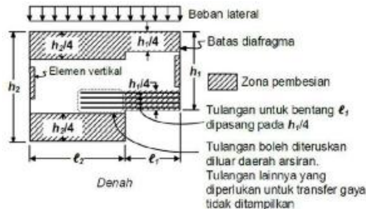
Gambar 5. Area penulangan kord pada diafragma Sumber :
