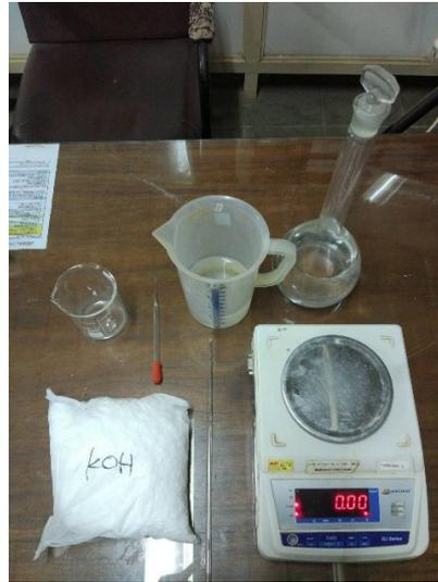
**Gambar 2.** Alat yang digunakan untuk pembuatan larutan kalium hidroksida
