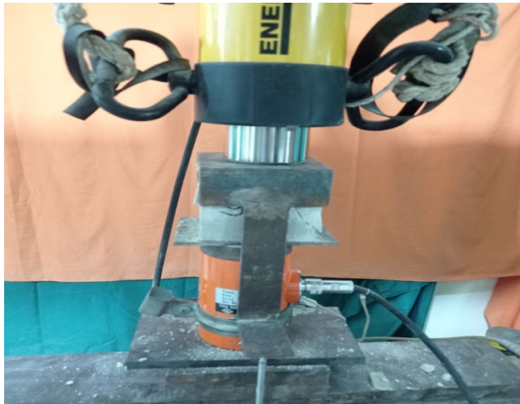
Gambar 6. Pengujian Sampel Mortar Bata Ringan
