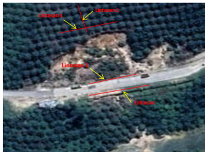
Gambar 5. Denah Lintasan Pengukuran Geolistrik
