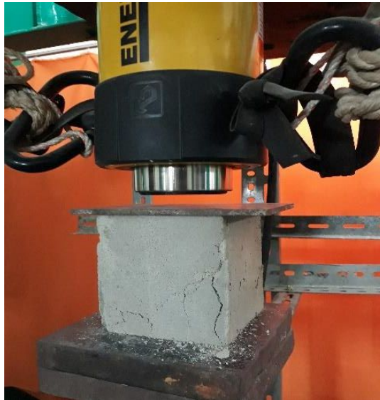
Gambar 5. Keruntuhan Variasi 10% POFA Trial Mortar umur 28 hari
